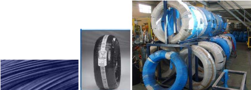
El alambre fosfatado de nuestros muelles es conforme a las normas EN10088-3, ISO 6931 y EN 10270-3. Respeto las reglas de Montreal en cuanto a los C.F.C. y es conforme a la reglamentación europea sobre los metales pesados. Certificados ISO TS 16949, ISO 9001 versión 2000 e ISO 14001.
