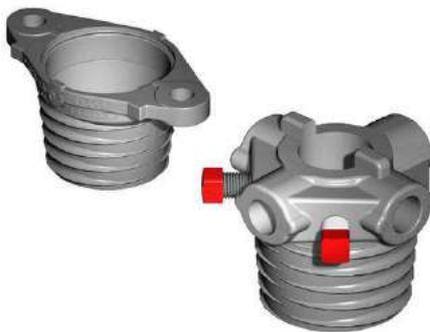
Piezas de torsión para muelles de  $\text{Ø}152\text{mm}$  en aluminio, con sistema universal para ejes de  $\text{Ø}25,4\text{mm}$  y  $\text{Ø}31,75\text{mm}$ . Compuestas por una pieza móvil y una fija. Máx. Torsión: 226Nm Peso: 1,75 kgs el juego.
