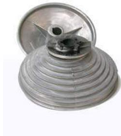
Tambor 1100-18 RH/LH de enrollamiento de aluminio para eje de  $\text{Ø}25\text{mm}$  y cable de elevación de máximo  $\text{Ø}5\text{mm}$ . Peso por unidad 1,76 kgs (se montan uno izquierdo y uno derecho). La altura máxima de la puerta será de 5590mm a 0,5 vueltas de seguridad del cable de elevación y de 4403mm a 2,0 vueltas de seguridad del cable de elevación. Peso máximo de la puerta: 518 kgs. Diámetro total interior del tambor: 275,5mm. Altura del tambor: 108mm. Distancia cojinete: 152mm
