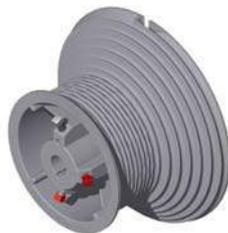
Tambor 850-11 RH/LH de enrollamiento de aluminio para eje de  $\text{Ø}25\text{mm}$  y cable de elevación de máximo  $\text{Ø}5\text{mm}$ . Peso por unidad 0,96 kgs (se montan uno izquierdo y uno derecho). La altura máxima de la puerta será de 3352mm a 0,5 vueltas de seguridad del cable de elevación y de 2990mm a 2,0 vueltas de seguridad del cable de elevación. Peso máximo de la puerta: 386 kgs. Diámetro
