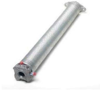
Piezas de torsión para muelles de  $\text{Ø}95\text{mm}$  en aluminio, con sistema universal. Compuestas por una pieza móvil y una fija. Máx. Torsión: 157Nm Peso: 0,78 kgs el juego.
