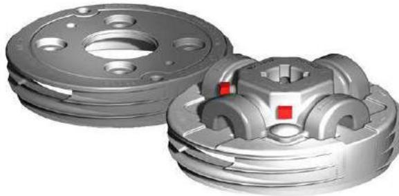
Piezas de torsión para muelles de Ø152/Ø95mm en aluminio, con sistema universal para ejes de Ø25,4mm. Compuestas por una pieza móvil y una fija. Máx. Torsión: 226Nm
