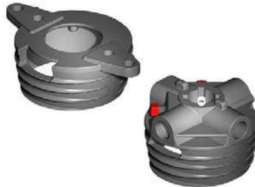
Piezas de torsión para muelles de  $\text{Ø}50,8\text{mm}$  en aluminio, con sistema universal. Compuestas por una pieza móvil y una fija. Máx. Torsión: 72Nm Peso: 0,28 kgs el juego.
